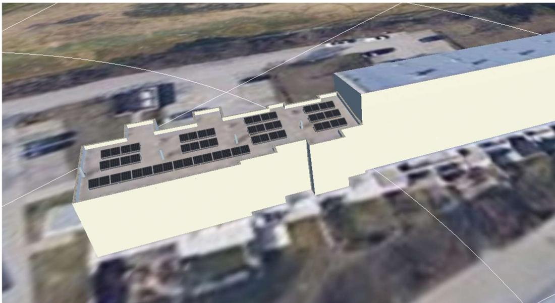
Bild 6: Anordnung PV-Module – Stiege 3
